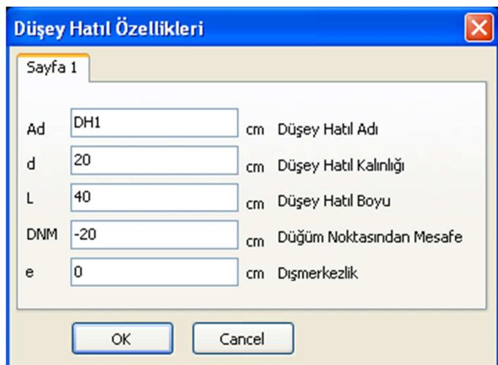
Bilgi girişinde Düşey hatıl adı kısmına bilgi girilmesine gerek yoktur. Program Düşey hatıl çizilirken isimleri otomatik vermektedir.
